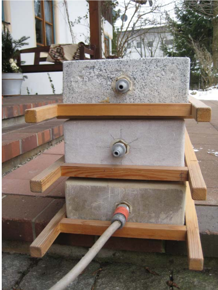
Durchleitung des Wassers bei verschiedenen Gesteinsarten Aus dem Kurs „Wasser - Spezial“ LOG.PER.MESSTECHNIK & MEDIEN, Prien 2010
